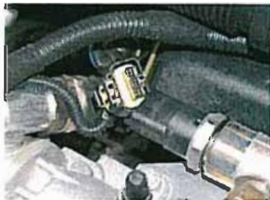
Das Railrohr, auch Druckspeicher genannt, verbindet die Kraftstoffleitungen zu den einzelnen Zylindern.
